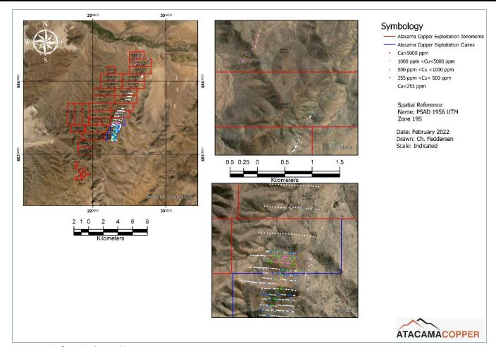
Fig. 4 IPBX Surface Geochemical Survey
